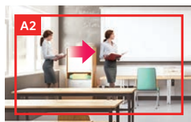
ターゲットが各エリアで移動しているときは、PTZ動作をしません。
